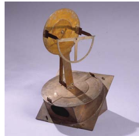
Torquetum (vormalig im Besitz von Nikolaus von Kues), ca. 1434, Messing © Bernkastel-Kues, St. Nikolaus-Hospital/ Cusanusstift
